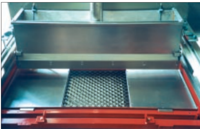
Dettaglio del sistema di caricamento della pressa (alimen- tatore ACP e griglia con stecche a nido d'ape) Detalle del sistema de carga de la prensa (alimentador ACP y rejilla con barras de nido de abeja)
