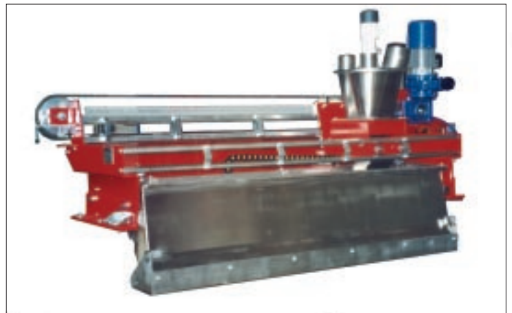
Alimentatore motorizzato ACM con bocca di lupo e mixer multicolor Alimentado motorizado ACM con tolva cónica y mixer multicolor
